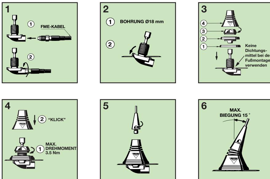
**BITTE BEACHTEN:** Es ist darauf zu achten, dass der Gabelschlüssel beim Anziehen der Befestigungsmutter (siehe Bild 4) in der korrekten Position geführt wird.
